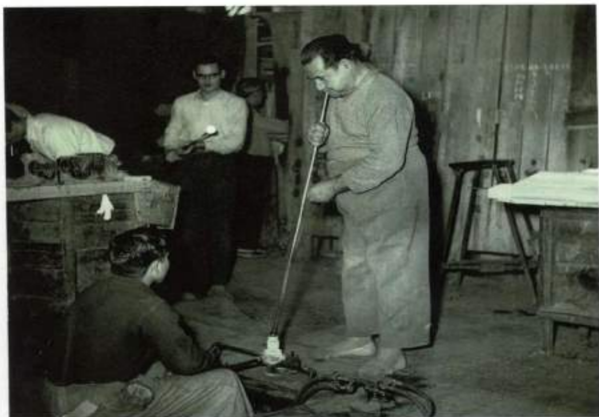
Vidrier de Cristalleries de Mataró fent bombetes amb motlle. Fotografia: Santi Carreras. ACM.
