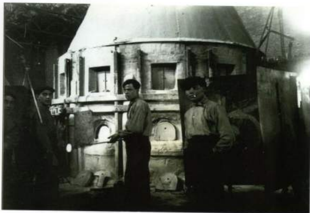
Treballadors de la fàbrica de vidre Giralt traient la pasta vitria d'un forn. Any 1917. Fons Arnau Izard i Llonch [1897-1993] - Fotografia 3391. Arxiu MNACTEC.
